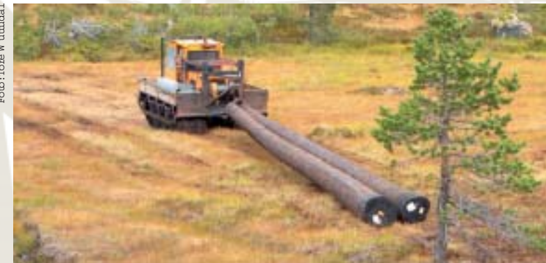
M uskeggen er arbeidshesten når tunge kresostolper skal fraktes ut i terrenget. Her fra Steinsdalen på Nord-Trøndelag side
